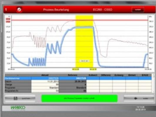
Einzigartige Funktion auf dem deutschen Markt: automatische Prozessbeurteilung zur Unterstützung des Bedieners bei der Prozessfreigabe und Erfüllung der Forderung der EN ISO 17665. Alle relevanten Prozessparameter werden automatisch mit der Validierungskurve verglichen. Bei Feststellung von unzulässigen Abweichungen werden Fehlermeldungen angezeigt.
